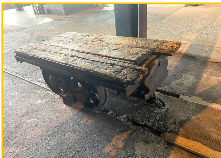
Dieser stabile kleine Wagen mit den schweren „Kampfspuren“ ist ein "Grubenwagen", auf dem auf den unterirdisch verlegten Gleise Gegenstände, u.a. Kohleabraum, hin und her transportiert wurden.
